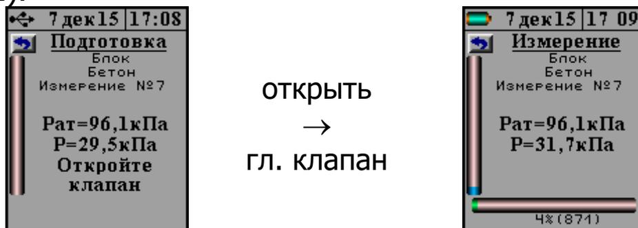
6.4.10 Дождаться окончания процесса измерения. Прибор автоматически вычислит сопротивление проникновению воздуха **m**, параметр воздухопроницаемости **a** и марку по водонепроницаемости **W**. Эта информация будет выведена на дисплей и сохранена в памяти прибора.
