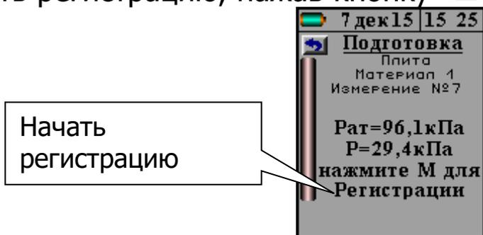
После нажатия кнопки **М** начнется запись процесса измерения давления, и прибор выдаст сообщение о необходимости «**Открыть клапан**». Одновременно с этим будет запущен таймер обратного отсчета времени, в течение которого нужно нажать кнопку 6 с маркировкой «**Главный клапан**» (рисунок 1.1). Откроется клапан 7, находящийся на нижней поверхности прибора.
