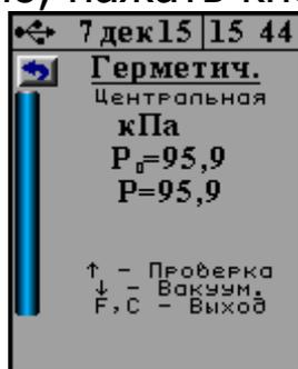
6.3.3 По достижении в камере вакуумметрического давления равного  $P_{\text{вак}} \geq 65$  кПа ( $P_{\text{абс}} \leq 35$  кПа) насос выключится. После нажатия кнопки **↑**, запустится процесс проверки герметичности.
