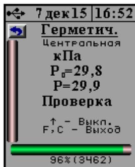
По окончании часа измерений программа выдаст сообщение о герметичности прибора. Если давление изменится менее чем на 2 кПа, то прибор является герметичным и может поступить в эксплуатацию.
