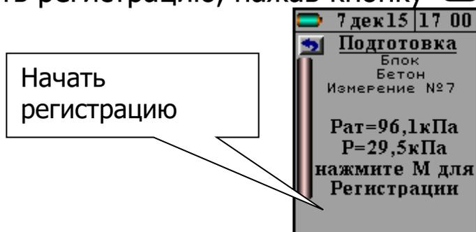
6.4.9 Начать измерение, нажав кнопку **М**, и в течение 1 минуты открыть главный клапан, повернув переключатель 6 с маркировкой «**Главный клапан**» в положение «**ОТКРЫТ**» (Рисунок 1.1).
