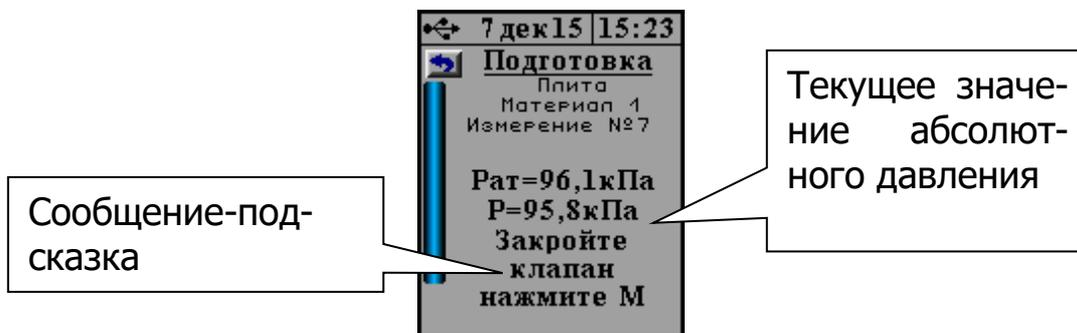
Для облегчения работы с прибором в режиме измерения на дисплей выводятся подсказки о порядке требуемых действий. Поэтому после активации этого режима оператору будет предложено закрыть главный клапан и создать в камере необходимое вакуумметрическое давление с помощью встроенного насоса, однократно нажав кнопку **М**. Вакуумный насос создаст требуемое вакуумметрическое давление и автоматически выключится.
