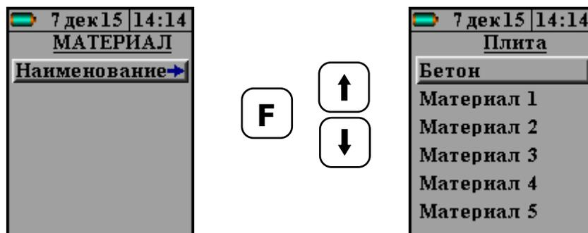
Этот пункт меню содержит один стандартный материал - бетон, для которого в программе прибора уже установлена корреляция между маркой по водонепроницаемости  $W$  и сопротивлением проникновению воздуха  $m$  (ГОСТ 12730.5 Приложение Д), и 19 программируемых (Материал-1, -2,... -19).
