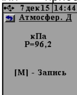
Сохраненное значение давления будет выводиться на дисплей в режиме измерения, и использоваться прибором в расчетах до тех пор, пока не будет повторена процедура измерения атмосферного давления.
