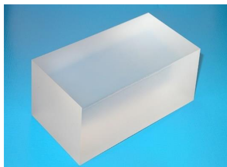
Рисунок 2 - Внешний вид рабочей эквивалентной меры прочности из оргстекла
