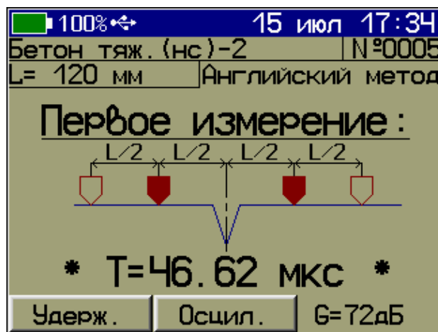
«Английский метод» измерения глубины трещины
