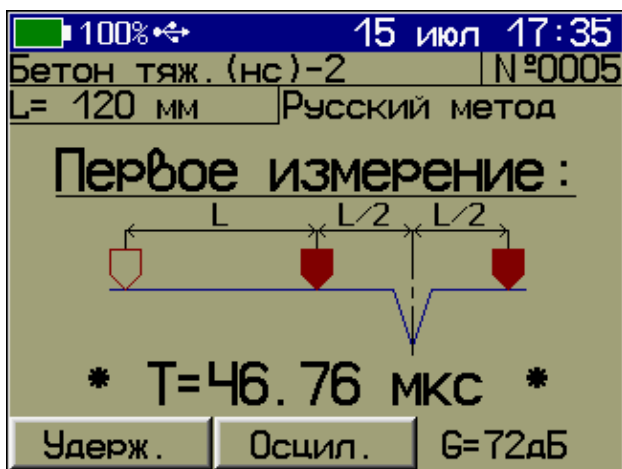
«Русский метод» измерения глубины трещины
