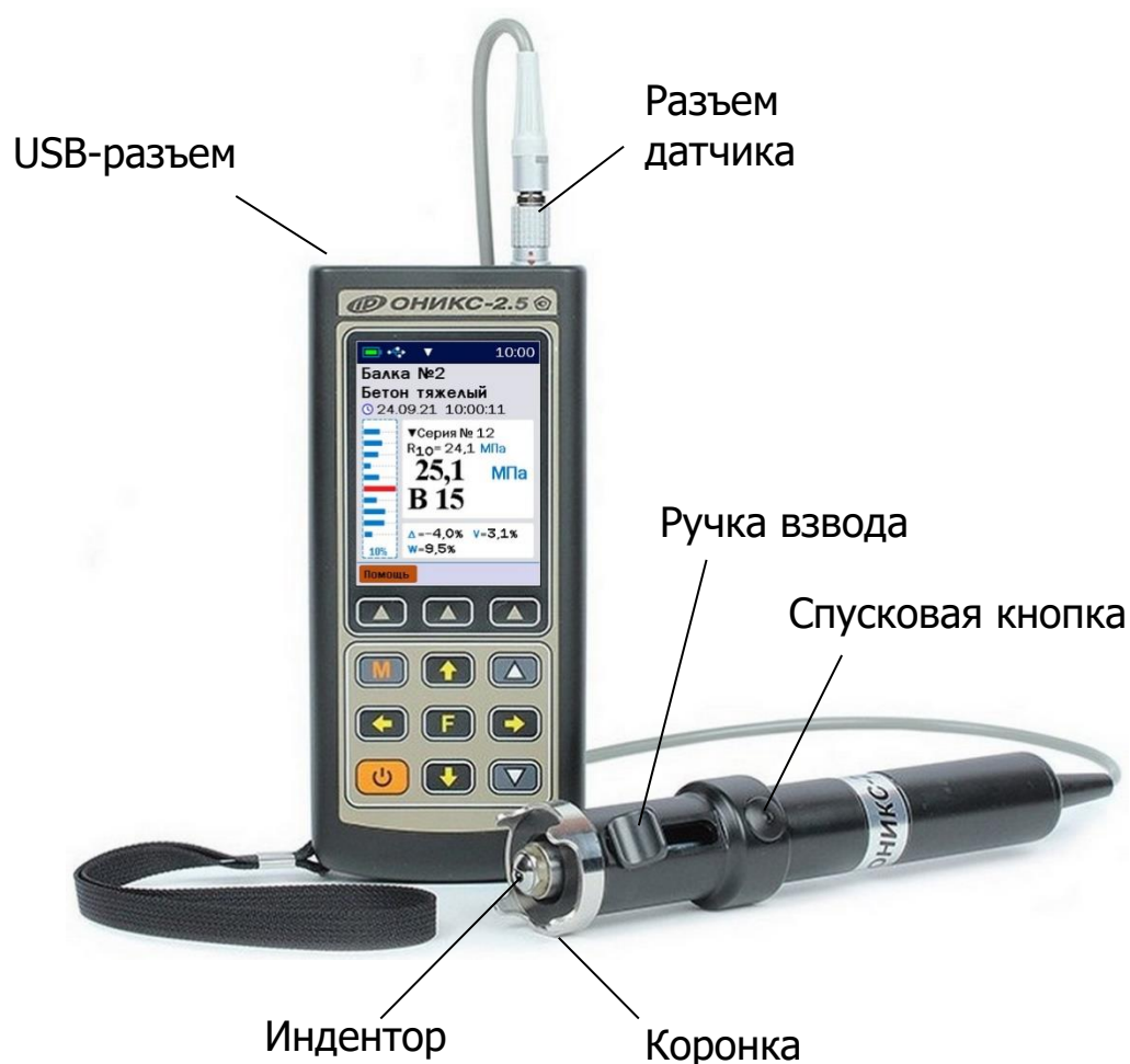
Рисунок 1 – Внешний вид прибора модификации «ОНИКС-2.5»
