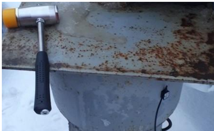
Рисунок 4 – Пример применения бокового датчика ВД-1002.02
