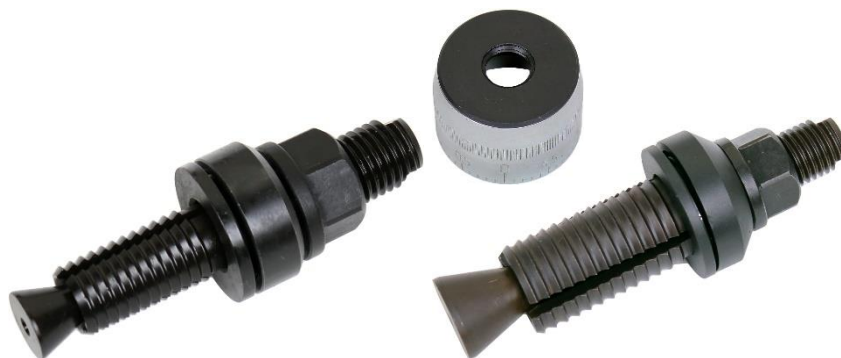
Рисунок 2 – Классические анкера и микрометрическая гайка
