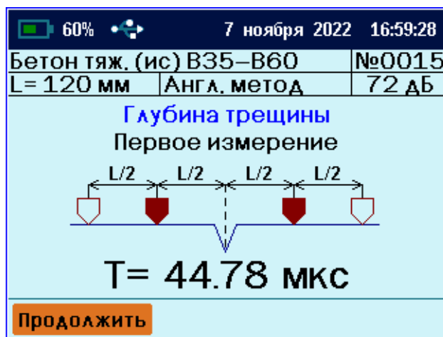
«Английский метод» измерения глубины трещины
