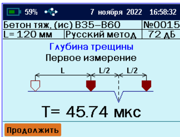
«Русский метод» измерения глубины трещины
