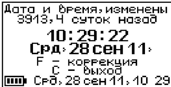
Если дата и время в нижней части экрана мигает, это означает что произошла остановка часов и необходимо задать точное время вручную.
