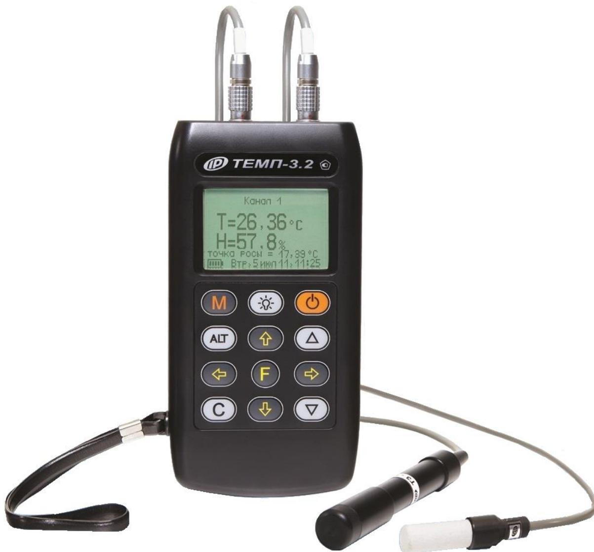
Рисунок 1 – Общий вид прибора TEMП-3.2 с датчиками температуры ТЗ-ПО и ДТГ
