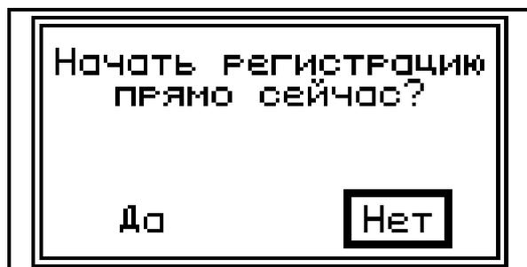
Если выбрать «да», то цикл регистрации начнется с немедленного измерения, прибор проведет измерение и отключится, перейдя в режим ожидания следующего измерения в соответствии с настройками режима запуска.
