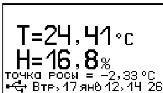
3.4.4.2 При работе с модификациями «ТЕМП-3.21» и «ТЕМП-3.22» на дисплее прибора будет отображаться следующая информация:
