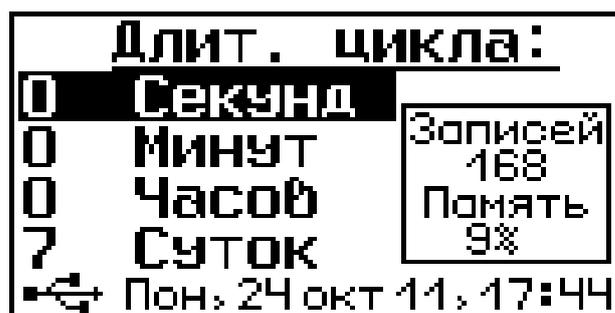
устанавливать интервал времени всей регистрации с помощью клавиш (↑), (↓), (▲), (▼). Длительность цикла не может быть меньше периода отсчетов, так как в одном цикле должен быть как минимум один замер. Во вспомогательном окошке справа отображается:
