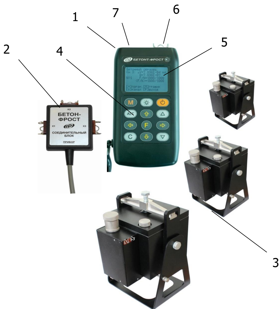
Рисунок 2 – Общий вид комплекса с тремя камерами
