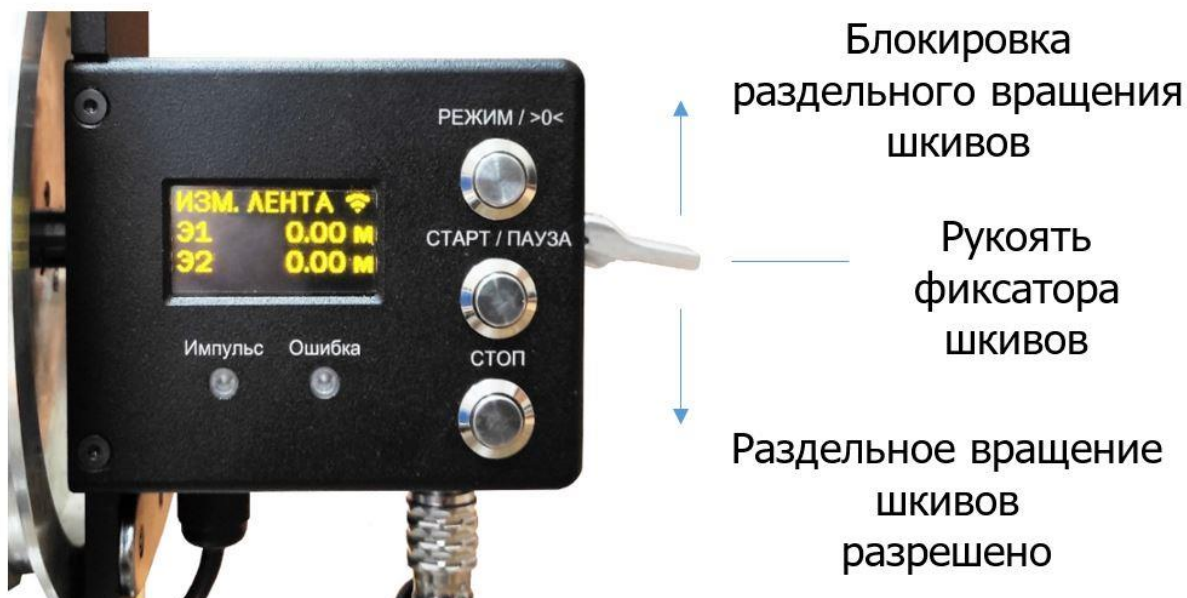
Рисунок 9 – Общий вид пульта управления БЭ
