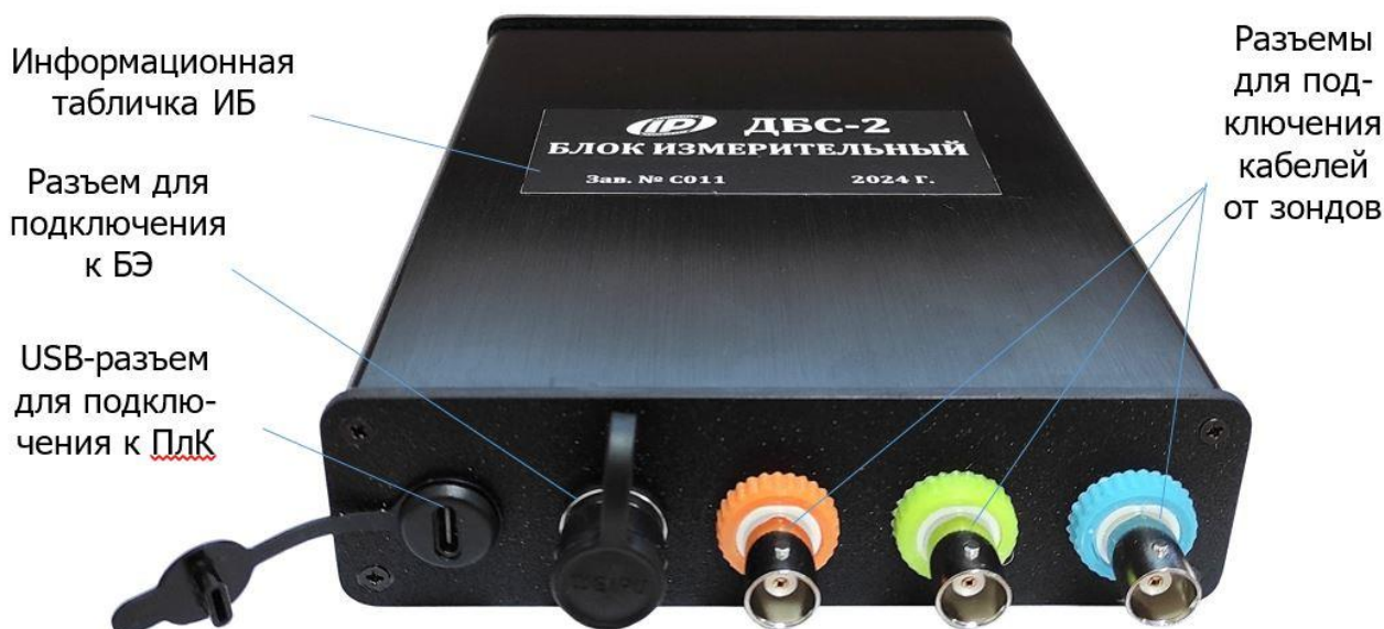
Рисунок 7 – Измерительный блок (ИБ) установки ДВС-2 (вид со стороны подключения разъемов кабелей от зондов)
