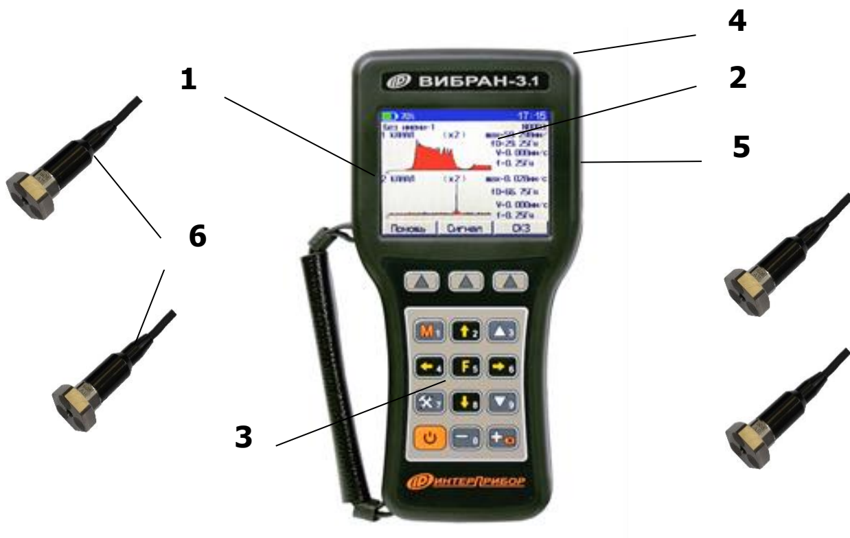
Рисунок 1 – Общий вид приборов ВИБРАН-3.1, ВИБРАН-3.2
