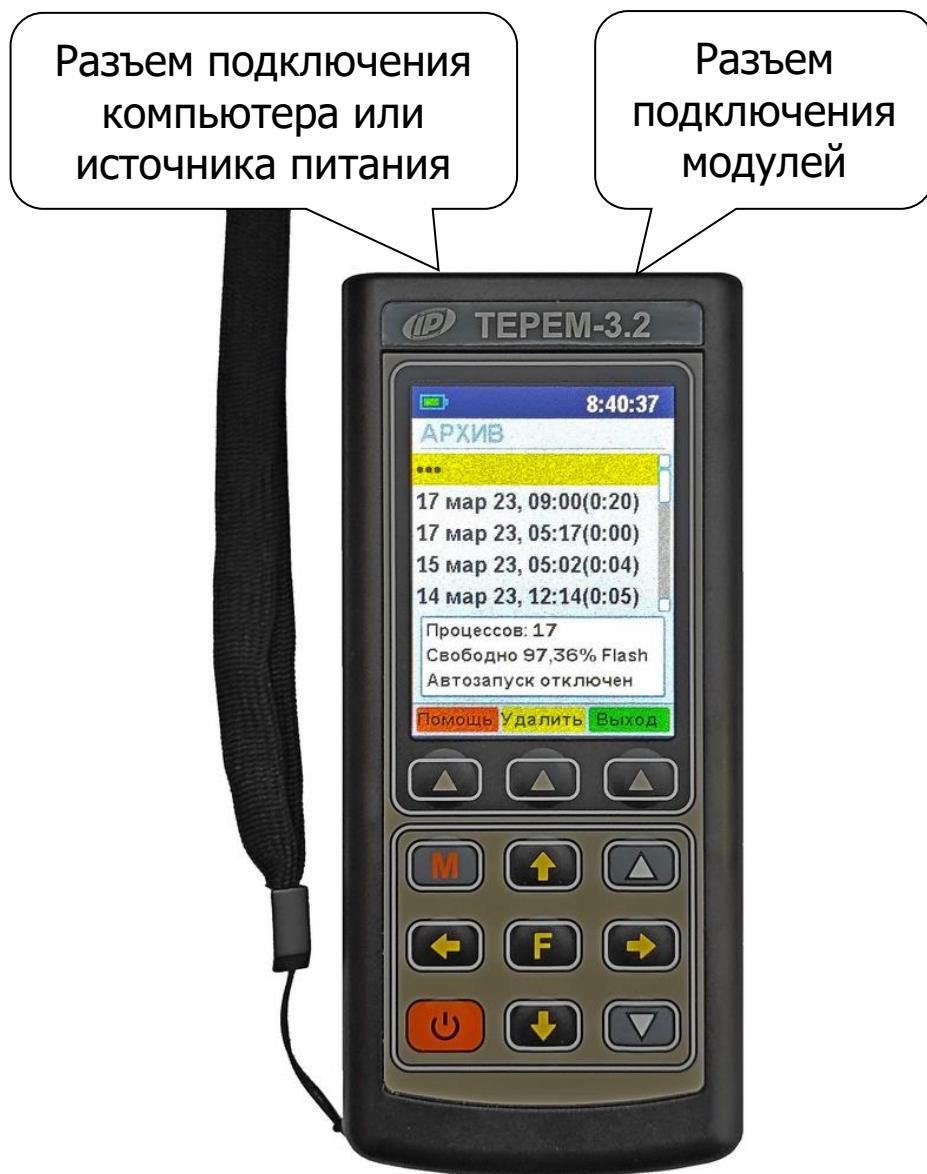
Рисунок 3 - Внешний вид центрального устройства
