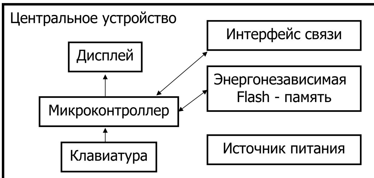
Рисунок 2 - Структурная схема центрального устройства
