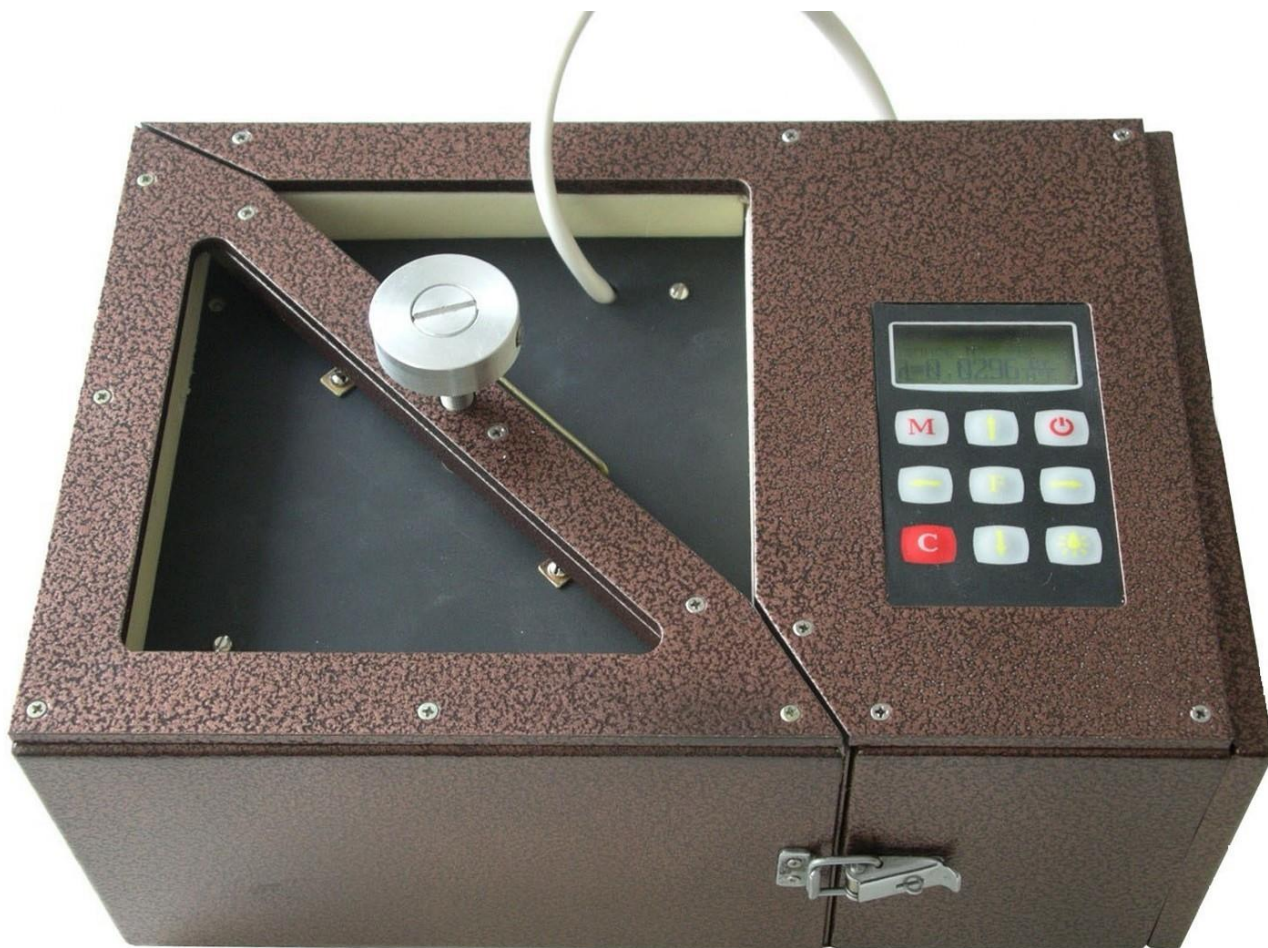
Рисунок 1 – Внешний вид измерителя теплопроводности ИТС-1
