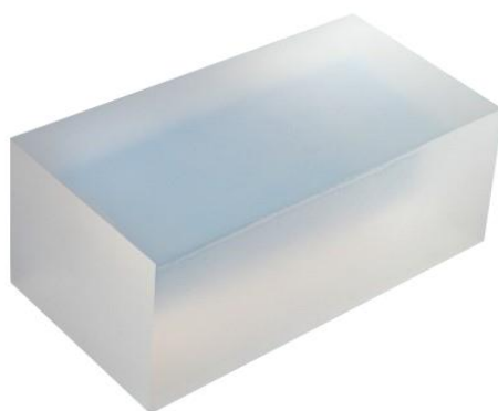
Рисунок 2 - Внешний вид рабочей эквивалентной меры прочности из оргстекла
