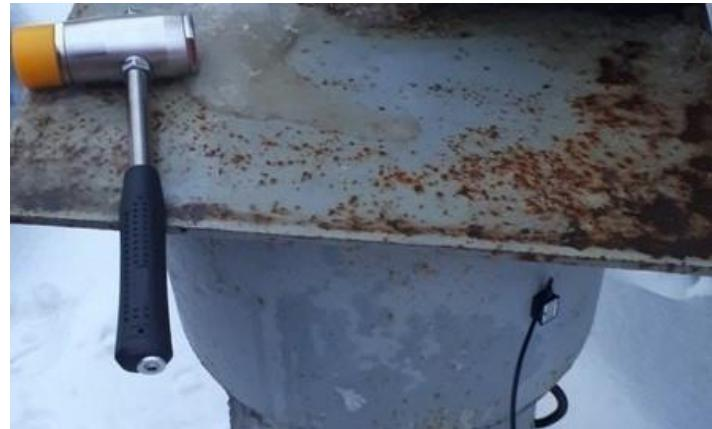
Рисунок 4 – Пример применения бокового датчика ВД-1002.02
