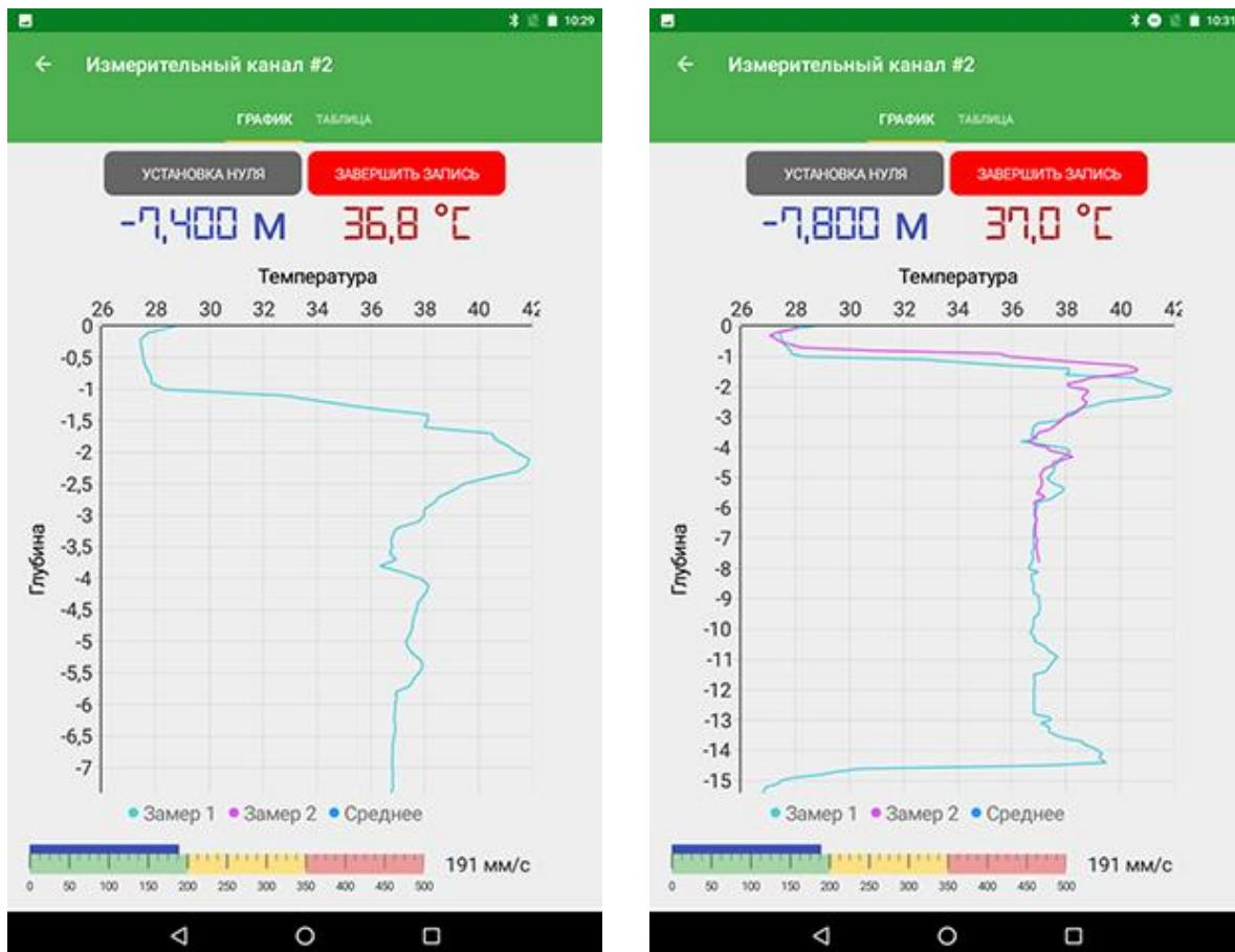
6.3.5 Повторите измерение по пп. 6.3.1-6.3.4 для текущего контрольного канала. По окончании второго измерения прибор автоматически рассчитает среднее значение двух измерений.
