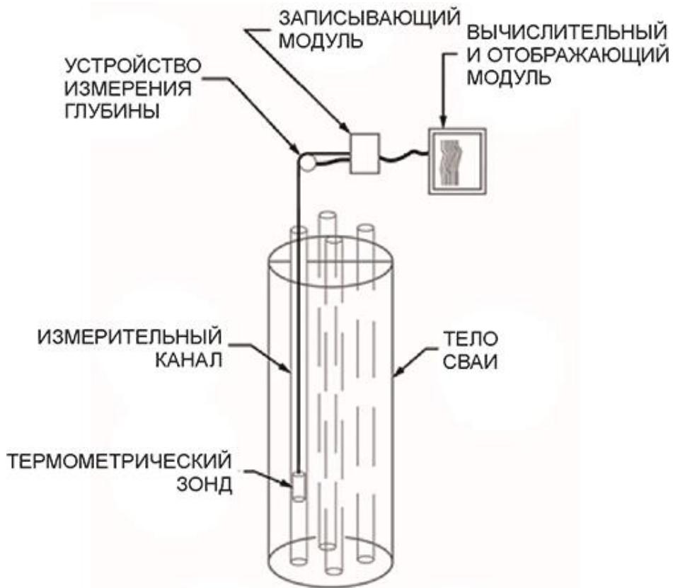
Рисунок 1 – Схема измерения
