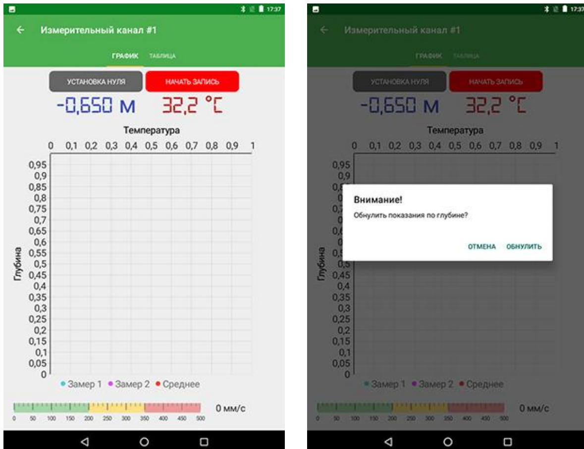
6.3.2 Опускайте термозонд вниз ко дну контрольного канала до тех пор, пока зонд не достигнет дна канала или не столкнется с препятствием (например, контрольный канал может быть замят, согнут или заблокирован).
