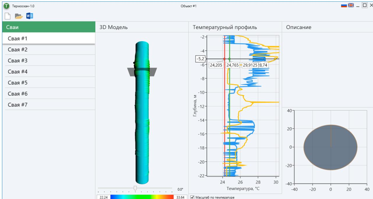
После выбора в левом окне интересующего объекта, в остальных окнах открываются: 3D-модель объекта, график температурного профиля объекта и профиль попечерного сечения температурного профиля объекта, отмеченный на 3D-модели лезвием сечения.
