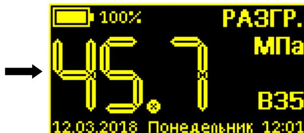
Вместо мигающего номера измерения появляется название текущего режима измерения - нагружение («**НАГР.**»), разгрузка («**РАЗГР.**»).
