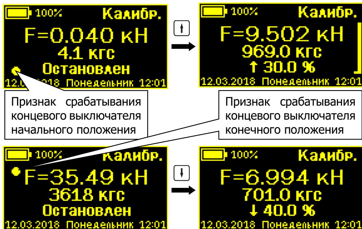
Нажав один или несколько раз кнопку , можно включить двигатель в режим увеличения силы нагружения, при этом в нижней строке вместо надписи «**Остановлен**» будет выводиться значение скорости двигателя в процентах от максимальной. В правой части дисплея появится шкала скорости нагружения, крайние значения
