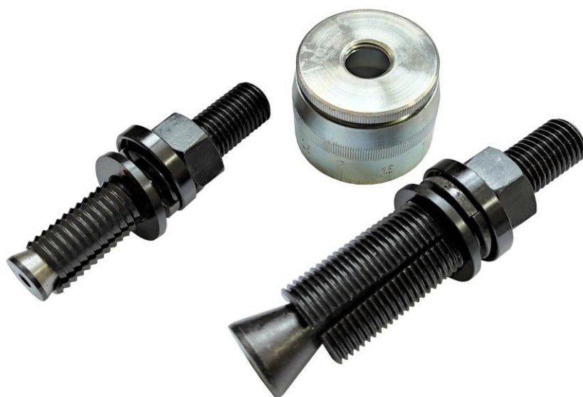
Рисунок 2 – Классические анкера и микрометрическая гайка
