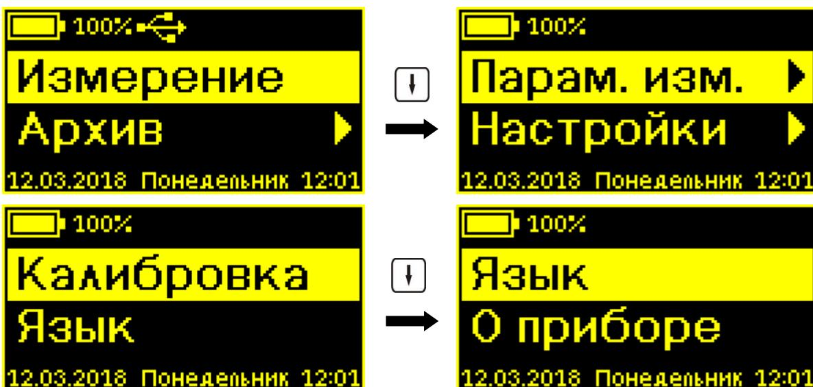
Верхняя и нижняя статус-строки отображают текущую информацию об уровне заряда аккумуляторной батареи, подключении прибора к компьютеру (значок ), дате и времени. Встроенные часы устанавливаются автоматически при управлении прибором из программы, установленной на смартфоне или компьютере.
