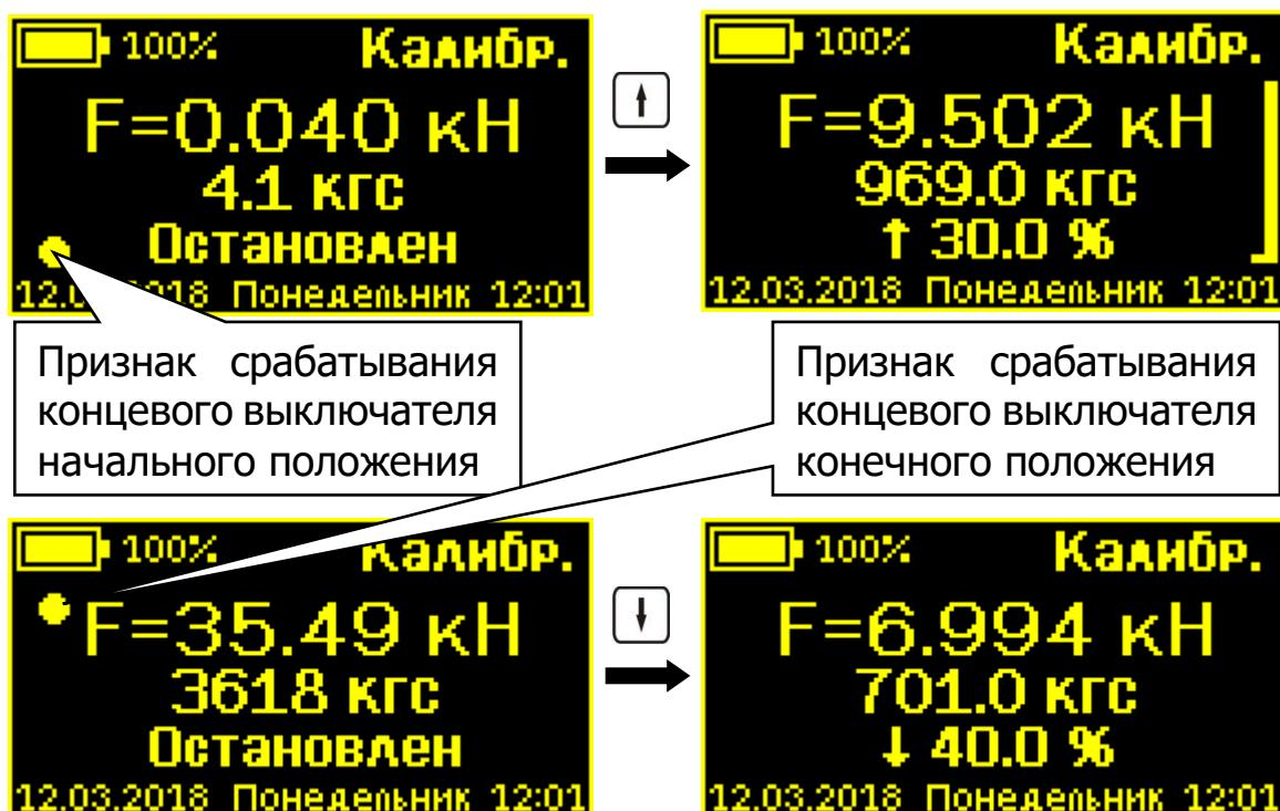
Нажав один или несколько раз кнопку ↑, можно включить двигатель в режим увеличения силы нагружения, при этом в нижней строке вместо надписи «**Остановлен**» будет выводиться значение скорости двигателя в процентах от максимальной. В правой части дисплея появится шкала скорости нагружения, крайние значения которой (1,5 кН и 3 кН) соответствуют рекомендациям ГОСТ 22690 при проведении измерения.
