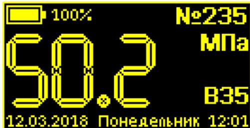
Использовать режим «Довырыв» необходимо в случае, если визуального отрыва фрагмента бетона после нагружения и локального разрушения конструкции так и не произошло.
