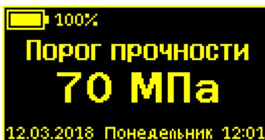
Значение выбирается в пределах от 5 до 200 МПа с шагом в 5 МПа. Если необходимо определить фактическую прочность бетона, то есть провести испытание до
