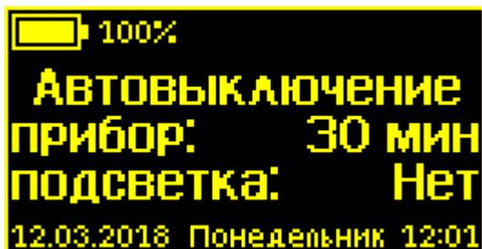
При входе в меню мигает значение времени автоматического выключения прибора, оно может быть изменено кнопками  $\uparrow$ ,  $\downarrow$ . После нажатия кнопки  $F$  значение запоминается, и начинает мигать значение времени автоматического гашения подсветки дисплея. После еще одного нажатия кнопки  $F$  запоминается значение этого параметра, а прибор возвращается в меню «Настройки».
