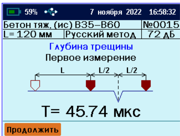
«Русский метод» измерения глубины трещины
