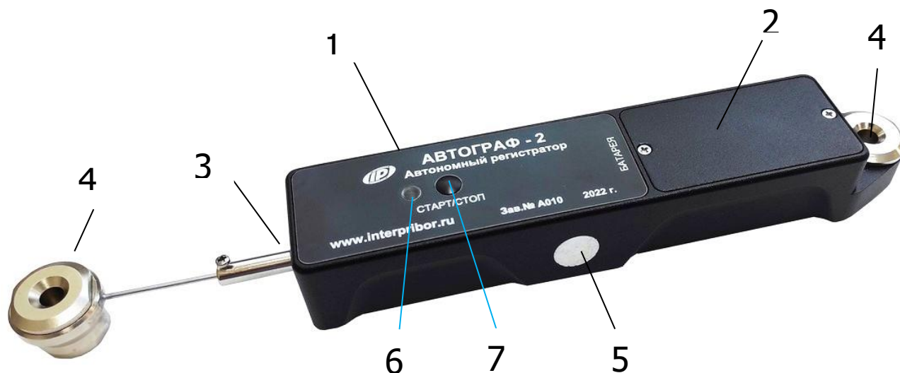
Рисунок 1 – Общий вид автономного регистратора «АВТОГРАФ-2»
