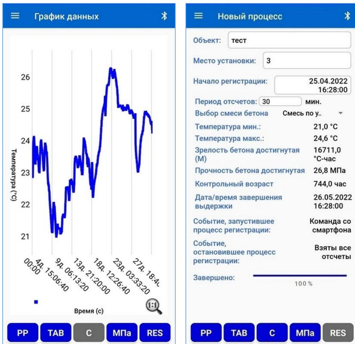
Рисунок 13 – Экраны архивных данных «Информация о процессе» и «Таблица данных»
