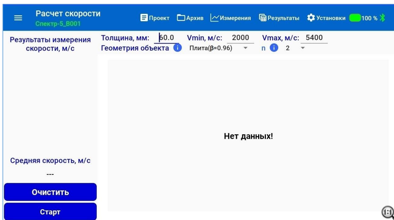
Рисунок 9 – Экран меню «Расчет скорости» при вводе граничных условий
