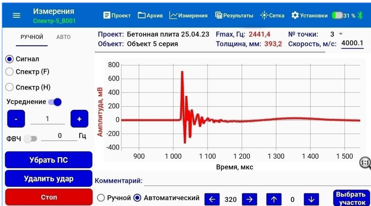
Рисунок 30 – Записанный сигнал после проведения измерения
