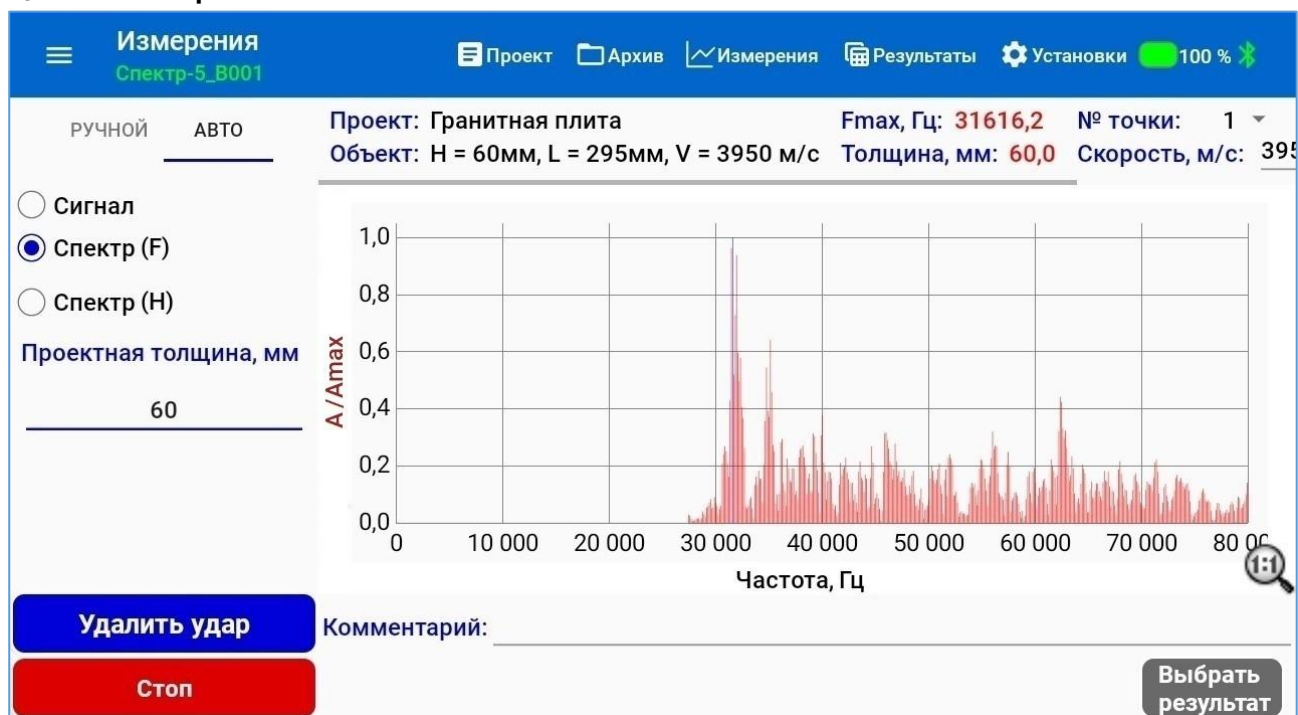
Рисунок 31 – Экран вывода графика амплитудного спектра сигнала в режиме «АВТО»
