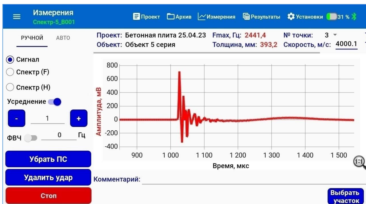
Рисунок 28 – Экран меню «Измерение». Записанный сигнал после включения инструмента «Убрать ПС»
