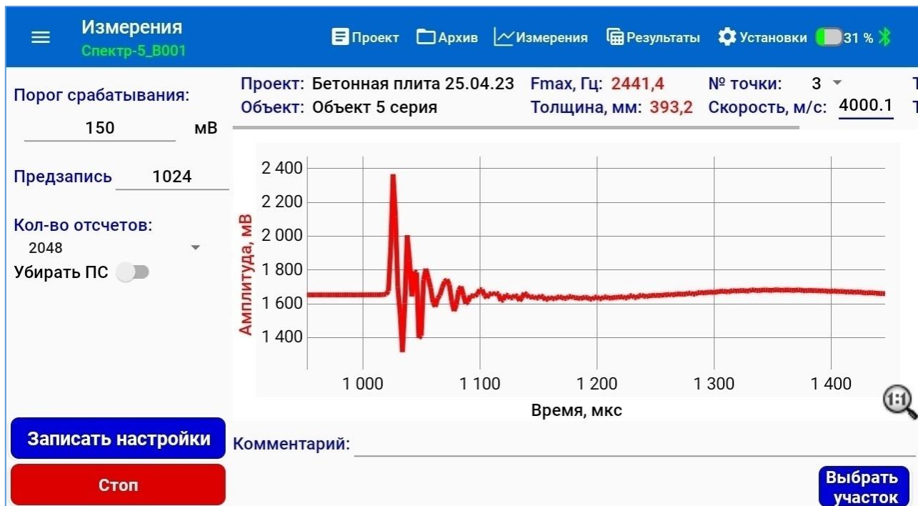
Рисунок 26 – Экран меню «Измерение». Ввод параметров настройки процесса записи сигнала
