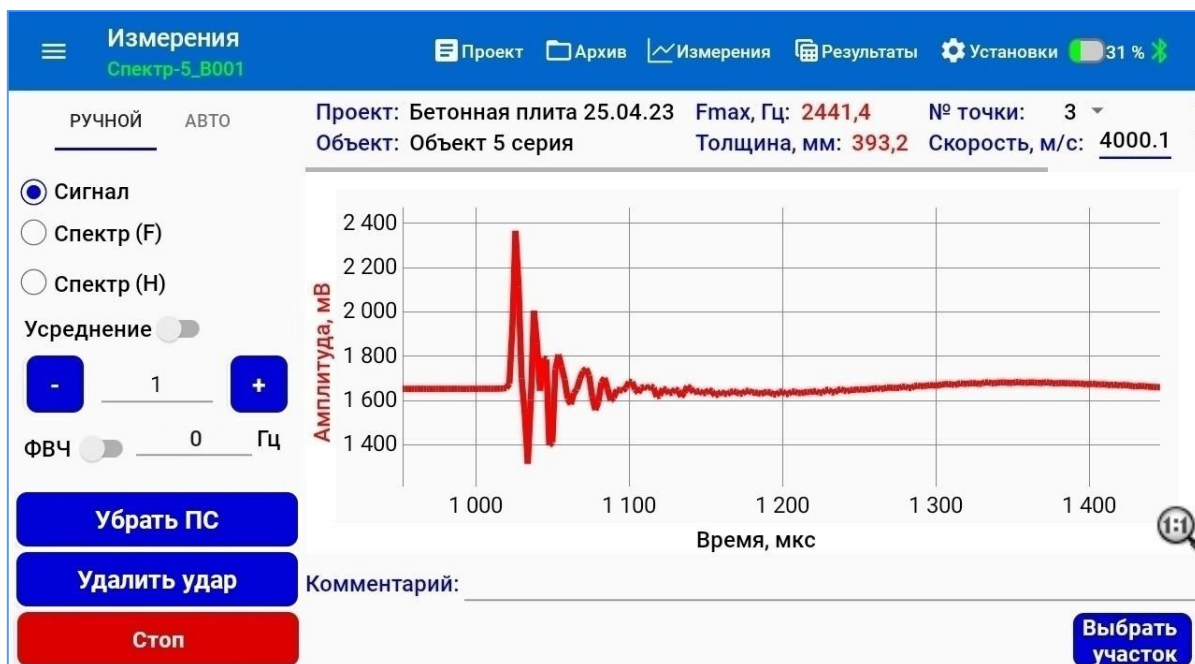
Рисунок 27 – Экран меню «Измерение». Записанный сигнал до включения инструмента «Убрать ПС»
