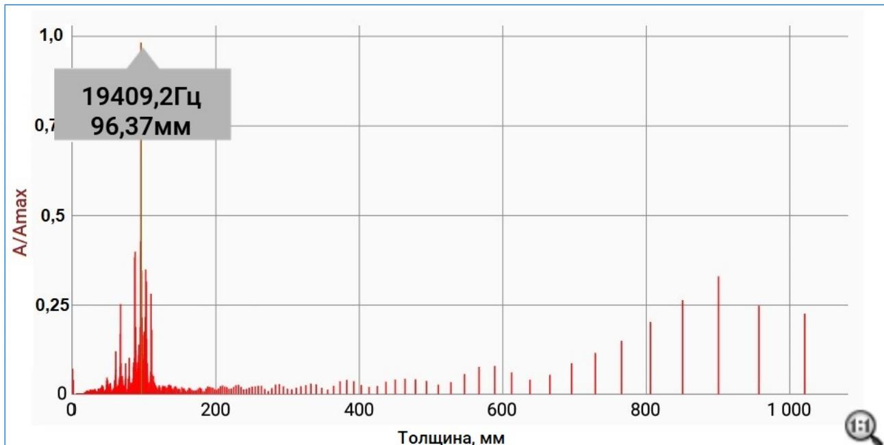
Рисунок 38 – Спектральная частотная характеристика сигнала с определением толщины объекта по максимальному соотношению  $A/A_{\max}$
