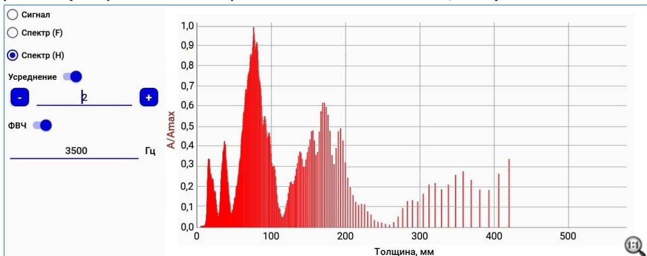
Рисунок 44 – Спектральная характеристика сигнала с определением толщины объекта по максимальному соотношению  $A/A_{max}$  и применением ФВЧ
