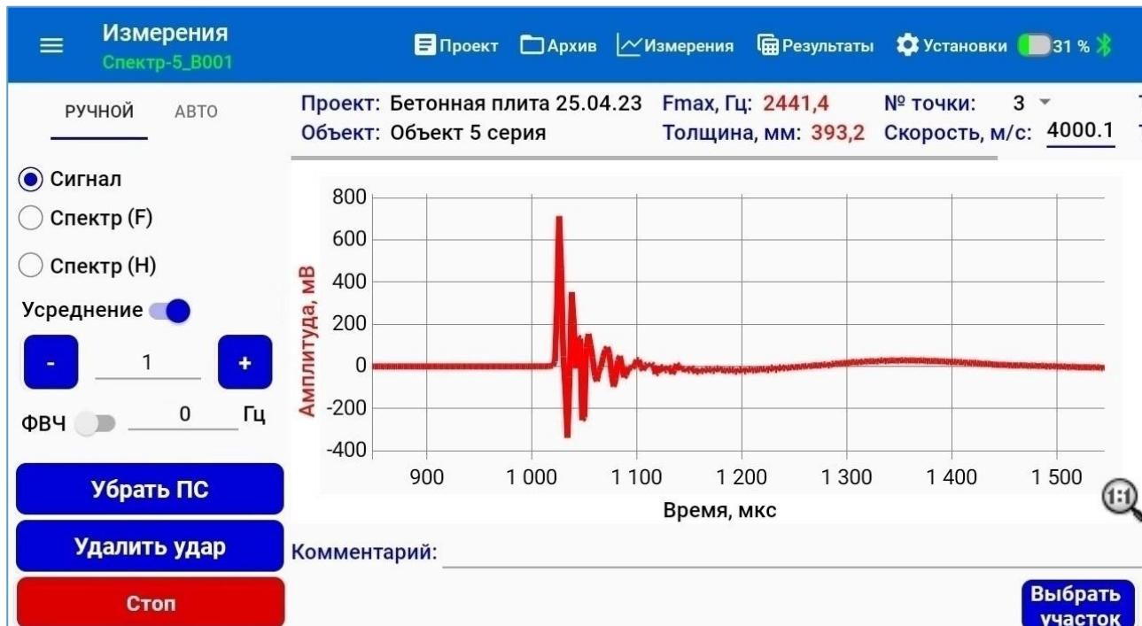
Рисунок 28 – Экран меню «Измерение». Записанный сигнал после включения инструмента «Убирать ПС»
