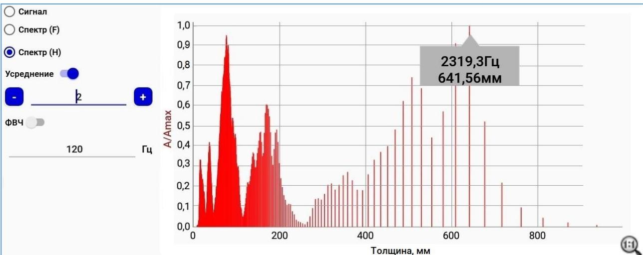
Рисунок 42 – Спектральная характеристика сигнала
