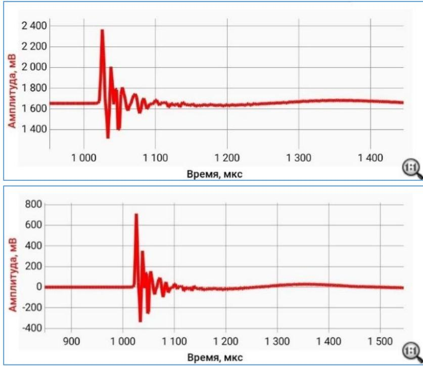
Рисунок 39 – Пример удаления постоянной составляющей
