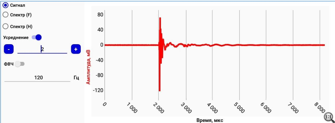
Рисунок 41 – Сигнал с применением усреднения  $N=2$
