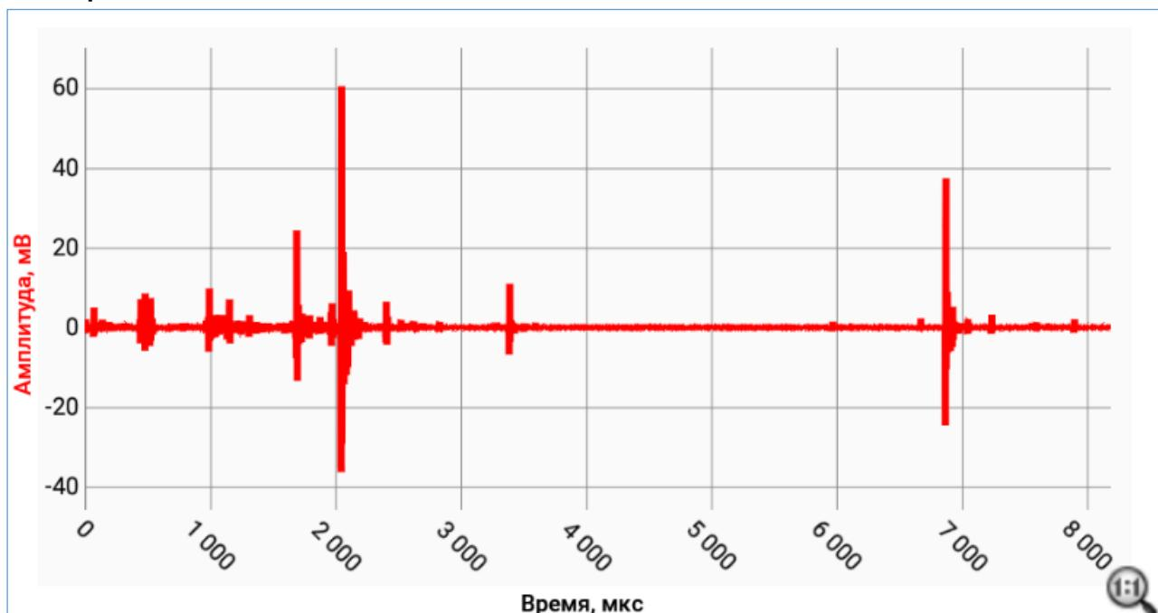
Рисунок 34 – Пример некорректного сигнала с удаленной постоянной составляющей
