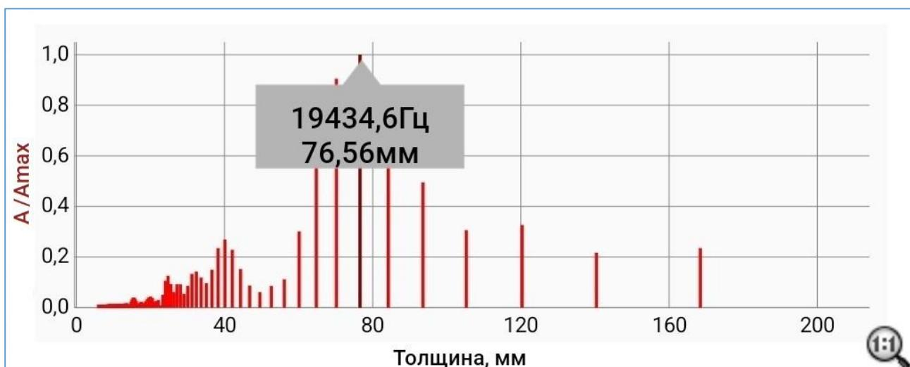
Рисунок 49 – Итоговая спектральная характеристика в диапазоне определяемых толщин
