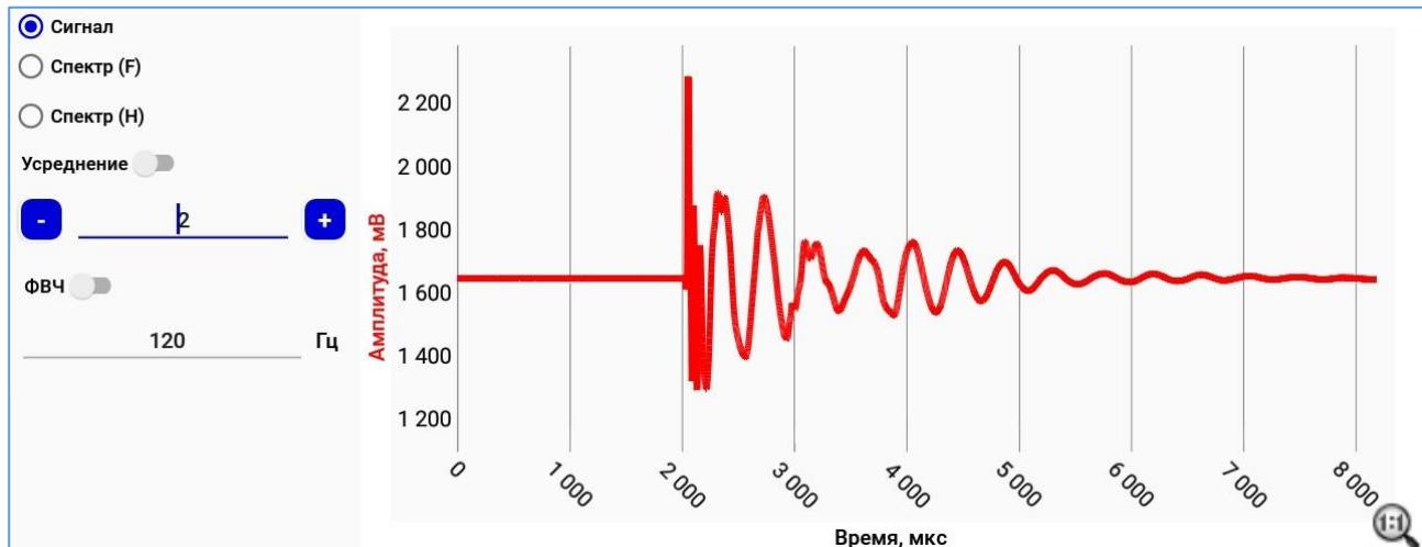
Рисунок 40 – Изначальный сигнал до применения усреднения
