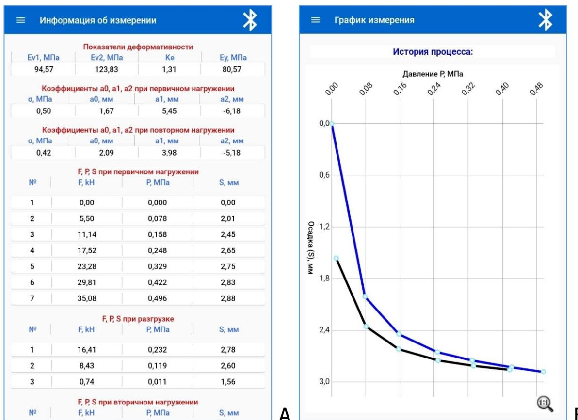
Рисунок 22 – Экраны архивных результатов измерений в табличном и графическом видах
