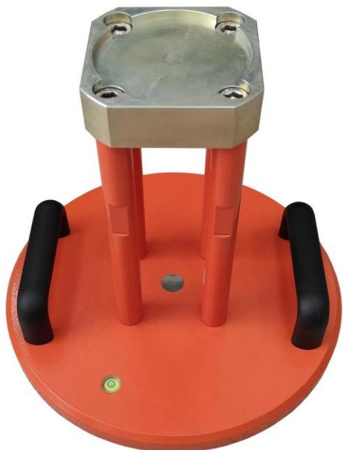
Рисунок 2 – Нагрузочная плита 300 мм с опорным блоком силоизмерительного датчика
