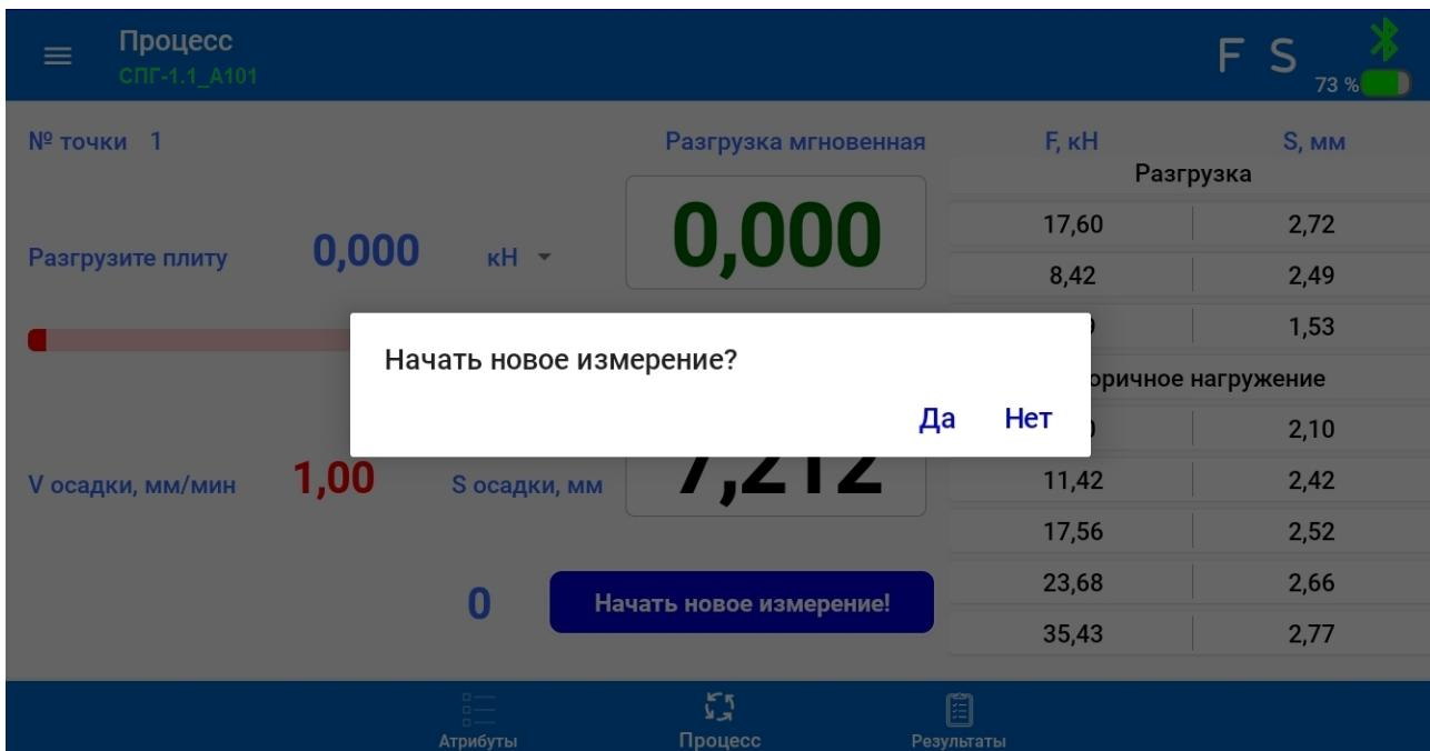
Рисунок 19 – Меню «Процесс», экран вкладки «Процесс», «Новое измерение»
