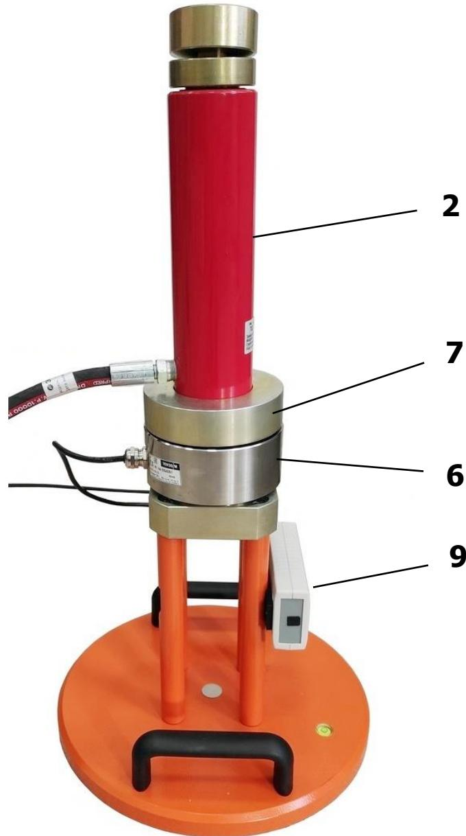
Рисунок 5 – Нагрузочная плита 300 мм
