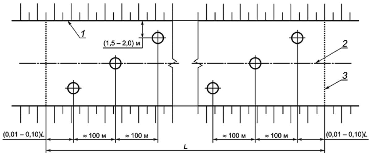
Рисунок 30 – Рекомендуемая схема расположения точек измерения методом статического нагружения
