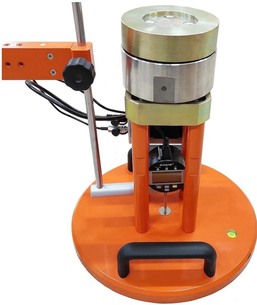
Рисунок 31 – Установка датчика перемещения
