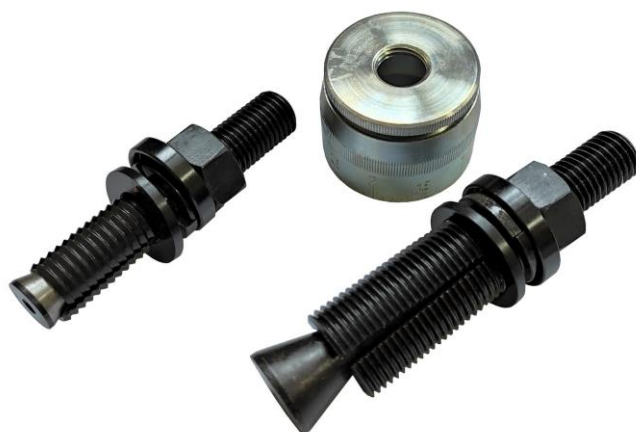
Рисунок 2 - Классические анкера и микрометрическая гайка
