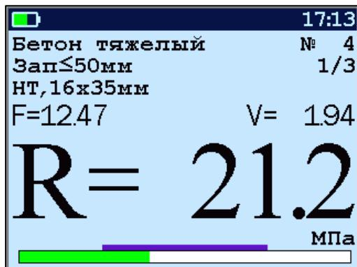
6.7.4 Произвести нагружение анкера до контрольного усилия по прочности бетона или до отрыва фрагмента.
