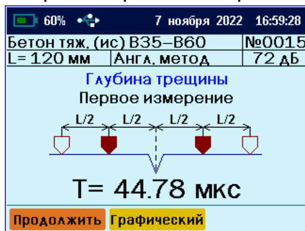
«Английский метод» измерения глубины трещины
